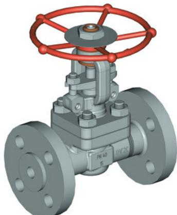
РТЗК54 — серия компактных клиновых задвижек с выдвижным шпинделем и жестким клином, креплением сальника на откидных болтах.
